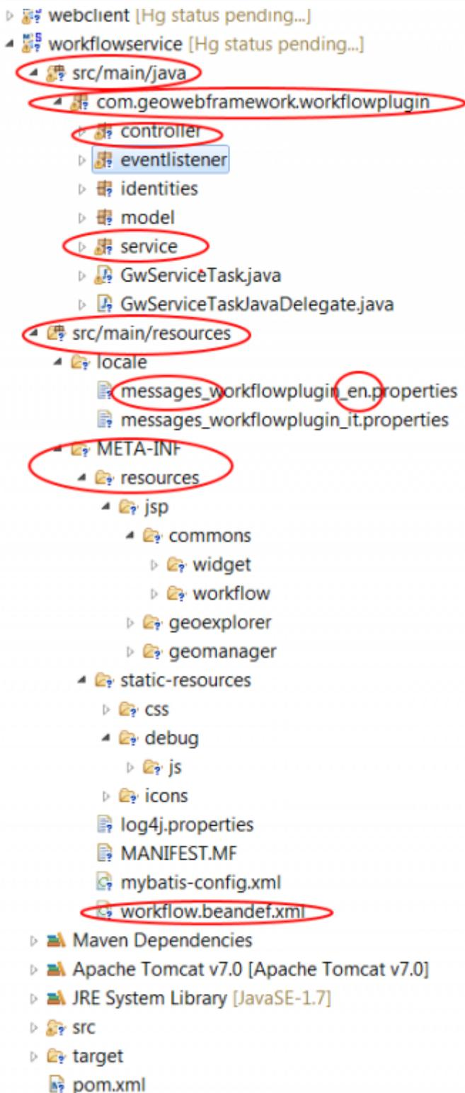
La sezione *src/main/java* ospita il package che segue per convenzione il pattern 'com.geowebframework.' + nomepluginminuscolo. Sempre per convenzione in genere vengono creati dei sotto package *controller*, *service* e *model* che ospitano le varie classi in base alla loro funzione.
