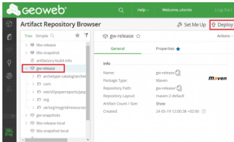
Dalla finestra che si apre, è possibile caricare il file, avendo cura di cambiare il groupId con “com.geowebframework” e di abilitare tutte le spunte disponibili; per terminare la procedura, cliccare infine **Deploy**. Si può, a questo punto, verificare il caricamento del progetto nel giusto percorso all'interno di gw-release.
